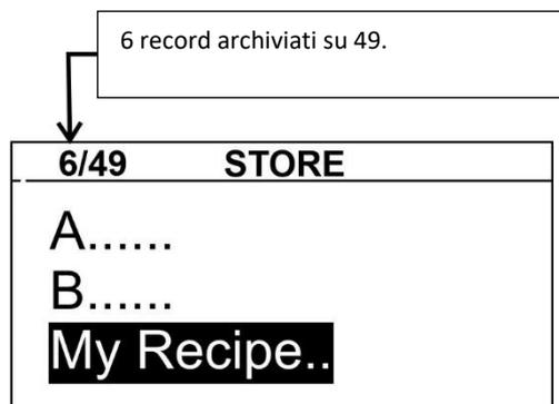
Le ricette memorizzate possono essere richiamate premendo il tasto F2 e selezionando i parametri del ciclo di saldatura appropriati.
